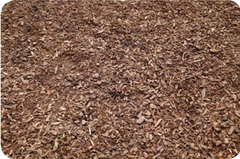
Fallschutzbeläge aus Holzsplittern, Rundkies oder Sand werden vielerorts als Fallschutz unter Spielgeräten eingesetzt. Fallschutzsande und -kiese sind nach einer bestimmten Korngrösse sortiert und relativ grosskörnig. Eine ideale Fallschutzwirkung bei Holzsplittern ist gegeben, wenn die Splitter gleichmässig und eben verteilt sind und der organische Abbau noch nicht fortgeschritten ist. Der Fallschutzraum muss für eine ideale Fallschutzwirkung jederzeit locker und vegetationsfrei sein.
